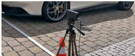
Lichtschranke: Das vordere Ende des Autos löst den Kontakt aus.
