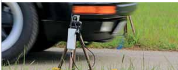
Lichtschranke: Das vordere Ende des Autos löst den Kontakt aus.
