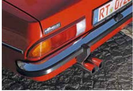
Zu Beginn mit Chrom, später aus Kunststoff: Stoßfänger.
