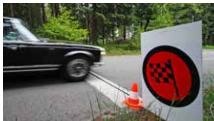
Schlauchprüfung: Das Vorderrad startet die Messung.
