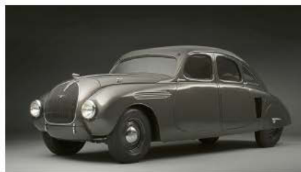
Der Škoda 935 von 1935 beeindruckt auch mit einem Zweiliter-Boxer vor der Hinterachse
