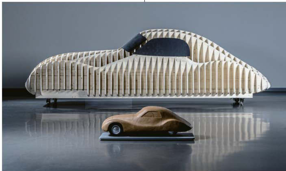
Prototypen Das Spantenmodell für die windschnittige Karosserie eines DKW F8 Stromlinie
